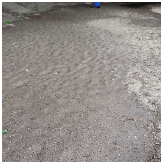
Figuur 6: geërodeerd leem afgezet in drainzand.
